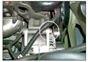
18. Remove the upper alternator bolt.
