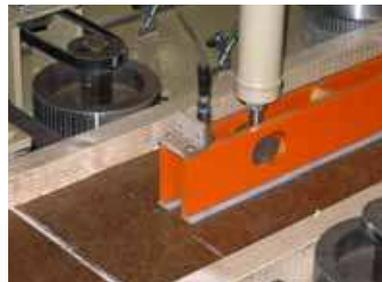
grande solidité lorsqu'ils sont soumis à des efforts de cisaillement. La préparation et l'assemblage de l'âme et des membrures à l'aide de liants résistants à l'humidité sont entièrement automatisés et utilisent les technologies les plus modernes.
